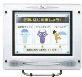
●脳年齢を中心に有効活用度などを測定することができます 脳年齢の要素には3つのポイントがあります。タッチパネル上の数字を順に 押して行く事で、記憶力と処理能力の低下傾向がわかります。1回目と2回目 の反応時間の差異などからすばやさ、脳の元気度、有効活用度を分析し、脳 年齢を総合判定します。
