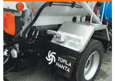
安全装置として、レーザータンク上昇・下降及びレーザータンクの開・閉を車両後部右側にてスイッチ操作が可能です。
