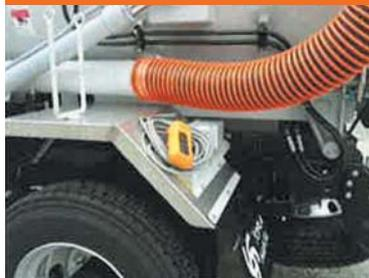
安全装置として、レーザータンク上昇・下降及びレーザータンクの開・閉を車両後部にてリモコン操作が可能です。
