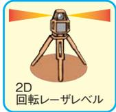
360°回転しながら水平にレーザー光を照射する回転レーザーと重機側に受光器を取り付け、重機の排土板の高さを検知しながら施工することで省力化と施工効率を高めるものです。マシンコントロールとマシンガイダンスに活用されています。使用条件は、重機側で常に受光できる範囲となります。
