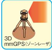
レーザー光を利用してRTK-GNSSの高さ方向の計測精度を向上させた技術です。GNSS基準局と移動局(重機)に加え、高さ精度を向上させる補完装置としてレーザー光を利用するシステムです。
