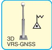
全国に設置された電子基準点(国土院/約1,200ヶ所)を利用した仮想基準点データによるネットワーク型のRTK-GNSSです。
