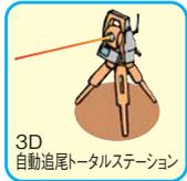
現場の座標既知点(基準局)に設置したTSにより、機械(移動局)に装着した全周プリズムを追尾し、機械の位置座標を計測します。適用可能な現場は、TSと重機側の見通しが確保されている必要があります。
