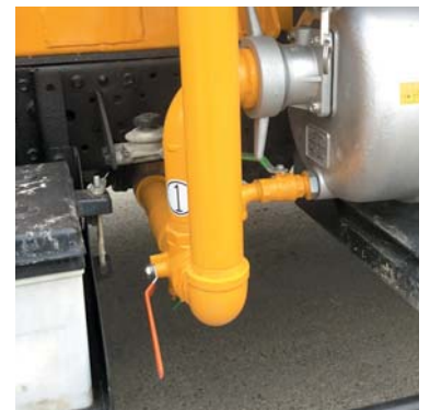
冬場の水抜きは2箇所!! 水抜きドレインを水ポンプ部に集約
